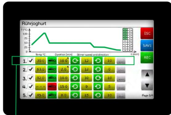
Beispiel der automatisierten Joghurtherstellung. Das Diagramm zeigt den gesamten Prozess mit den folgenden Hauptparametern: Temperatur - Wärmebehandlung, Rühren, Dosierung von Kulturen, Fermentation und Anzeige der Automatisierungsschritte, die zu Beginn bestimmt wurden.
