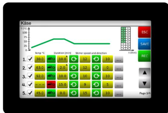
Beispiel für einen automatisierten Prozess der Käsemasseherstellung - der Grundlage für die Käseherstellung. Das Diagramm zeigt den gesamten Prozess mit den folgenden Hauptparametern: Temperatur - Wärmebehandlung, Rühren - die Harfen drehen sich in eine Richtung, Schneiden der Käsemasse - die Harfen drehen sich in die andere Richtung, Dosierung von Kulturen und Lab, Koagulation und Anzeige der Automatisierungsschritte, die zu Beginn bestimmt wurden.
