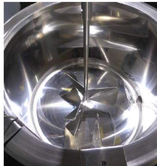
Mehrzweckerhitzer zum sofortigen Einsatz dank bereits vorinstallierten Programmen und mitgeliefertem Rührwerk.
